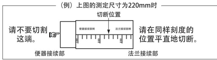
※因墙面安装有护墙板而导致便器无法安装时, 请切除护墙板。
