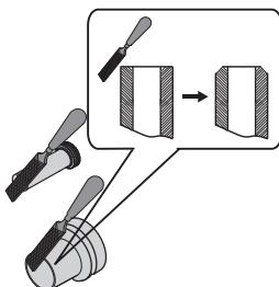
将锯短的两管管口端面打磨倒角(如图)，并去除毛边。
