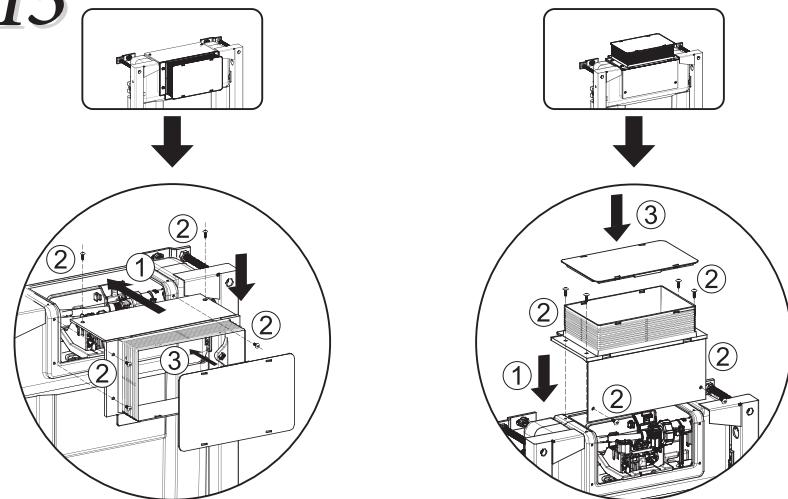
**！重要提示:** 在支架安装后砌墙前，务必通水并放置12小时以上，检查是否有渗漏现象。
