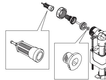
如图所示拆解进水阀，用水清洗过滤器或用刷子清除污物。
