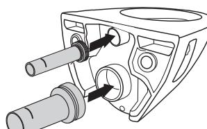
将直管分别插入冲水管和排水管到位，并画线标识。
