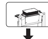
⚠ 重要提示：在支架安装后砌墙前，务必通水并放置12小时以上，检查是否有渗漏现象。
