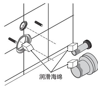
取出带有硅油海绵在直管与弯管的结合处抹上硅油。
