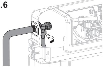
安装温水冲洗电子坐便器
