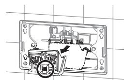
4. 将冲水阀的两根拉杆倾斜至右侧。
