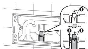
6. 拉起冲水阀，旋转拉杆。
