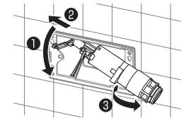
8. 冲水阀另一端的橡胶件可以拆下进行清洁或更换。
