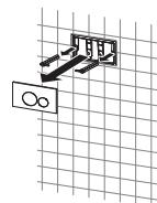
2. 关闭水箱中的进水角阀，然后按下驱动件上的按钮进行冲水。
