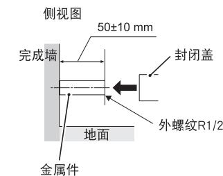
在安装止水栓之前, 请用封闭盖封住金属件。
