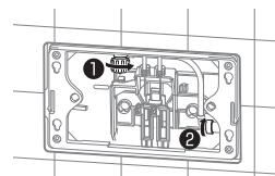
5. 将冲水阀的两根拉杆倾斜至右侧。
