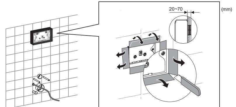
切割后的保护框如果超过了墙壁表面，导致面板没办法正确安装，可能会发生破损以及造成受伤的情况。
