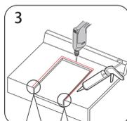
沿安装洗面器开槽轮廓线进行切割并打磨边缘, 在台面开口边缘涂上硅胶之类的密封材料。
