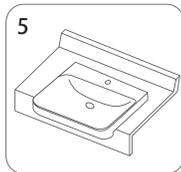
将洗面器小心放入台面开槽中, 安装后, 请使用防水的密封胶在洗面器和台面接触的四周边缘进行涂抹。
