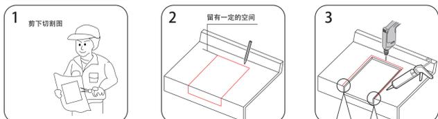
请沿剪切线将本纸剪开为施工说明书与安装用纸样两部分并将安装用纸样放在台面上。
