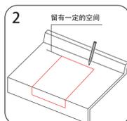
根据安装用纸样定位洗面器的安装位置, 用笔根据台面安装用纸样的边缘将台面开槽轮廓描绘在台面上。
