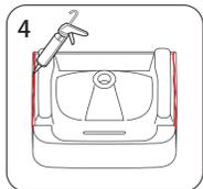
将洗面器倒置后, 在洗面器反面凹槽中涂上硅胶之类的密封材料。
