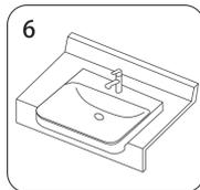
等密封材料硬化后, 将龙头按照其说明书上的要求指示安装到洗面器上。
