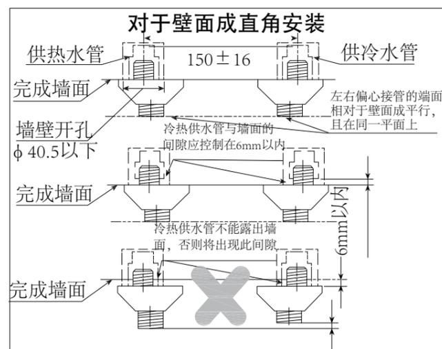
图1：偏心接管的安装
