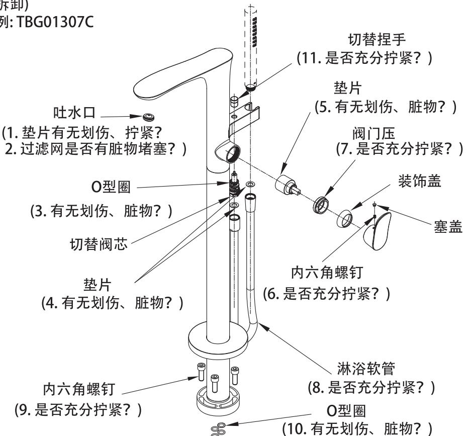
※不同示例产品的拆卸与原理基本相同。
