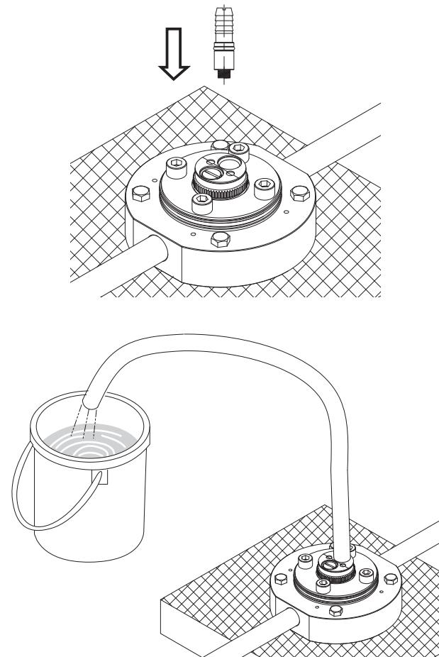
※如果对热水、冷水供水管不进行冲洗，管内的脏物、沙子等会对过滤网造成堵塞，以下的事项容易发生。 ①吐水量少②温度调节不顺畅。
