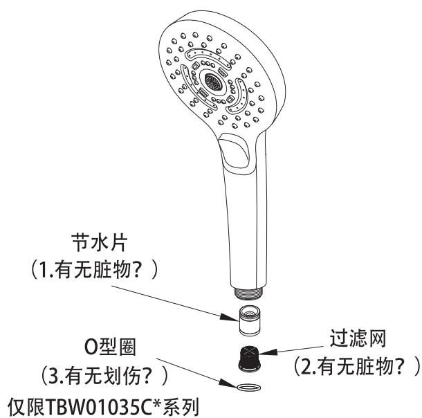
※注意：若出水不良, 请用手揉搓几下吐水不良的小橡胶凸起。
