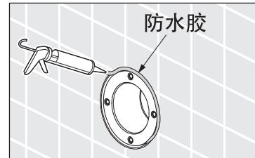
3.先把埋墙本体内部清洗干净，用六角扳手(对边2mm)将装饰板与阀体部拆开，再将阀体部插入固定接头内部(O型圈处涂抹肥皂水方便安装)，将阀体部衬板的螺钉安装孔与固定接头部的螺纹孔对齐，插入螺钉，用螺丝刀把螺钉紧固，衬板压到完成墙面即可。
