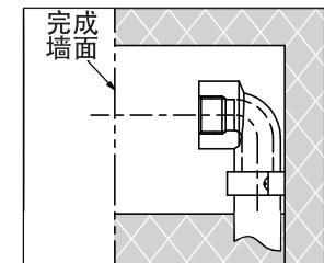
3.安装之前，一定要冲净供水管内的灰尘、砂砾等异物；安装过程中也应充分注意勿使泥沙等杂质进入水嘴或供水管内部。
