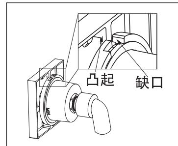
4.将装饰板上的凸起对准衬板的缺口插入，顺时针旋转装饰板，装饰板位置调正时，用六角扳手将装饰板下面的小螺钉旋紧，使装饰板固定。
