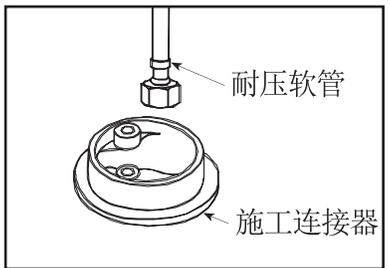
⑥ 先将一根耐压软管插入施工连接器。
