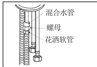
⑪ 最后将花洒软管与之前拆下的垫片及螺母连接好后，再与混合水管连接到一起。
