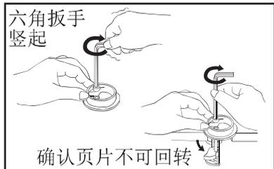
④ 将六角扳手竖起，紧固螺钉（确认页片是否打开）。
