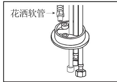
⑩ 再将花洒软管插入施工连接器。
