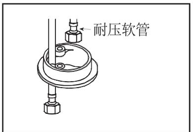
⑦ 将插入的耐压软管移到靠左侧后再插入另一根耐压软管。
