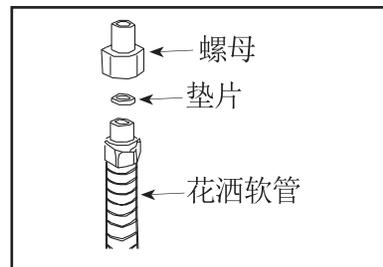
⑨ 将花洒软管前段的螺母拆下。
