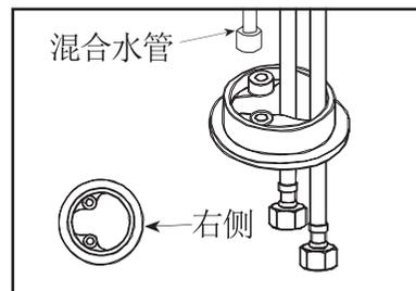
⑧ 将插入的两根耐压软管移到靠右侧后再插入混合水管。
